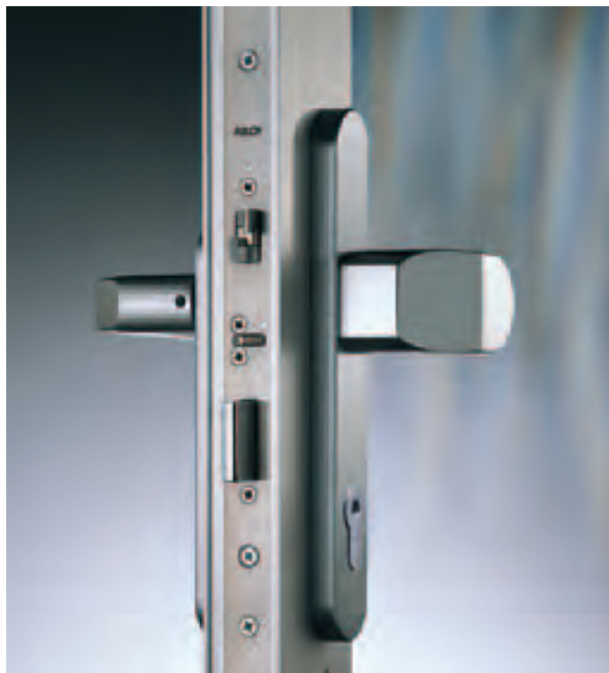
ABLOY EL426 Multipoint – elektromotorický úzký vícebodový zámek (rozteč 92 mm)
