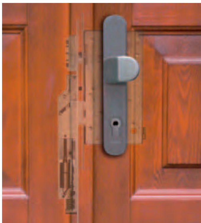
MEDIATOR – mechanický samozamykací hluboký zámek s elektromotorickým odjištěním (rozteč 72 mm)
